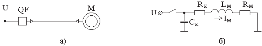
Рисунок 1 - Схема и эквивалентная схема фидера для питания двигателя
