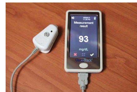
Рисунок 2 – GlucoTrack – устройство для неинвазивного измерения уровня глюкозы крови
