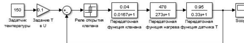
Рисунок 2 – Simulink-модель системы стабилизации температуры при напылении
