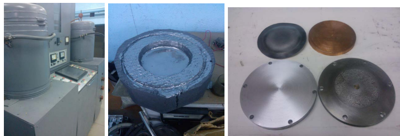
Рисунок 1 – Двухколпачковая вакуумная печь (а), графитовая форма для плавки металла (б), вид мишеней, полученных методом вакуумной плавки (в)
