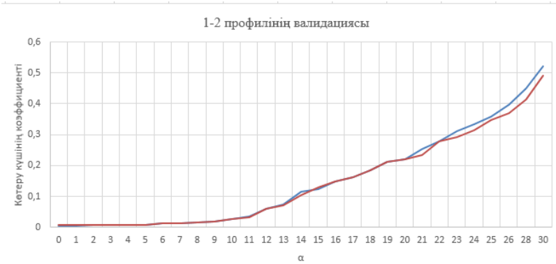
б) Параметр: қарсылық күшінің коэффициенті C_d 3-сурет – 1-2 профилі үшін C_l және C_d атқылау бұрышының тәуелділігі
