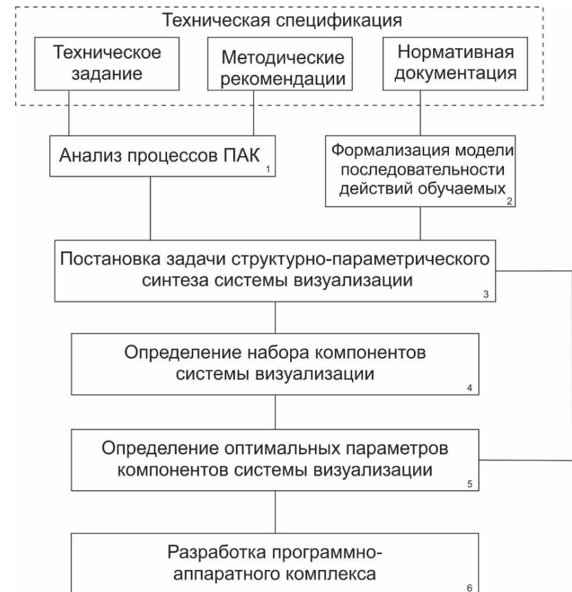
Рисунок 1 – Функциональная диаграмма структурно-параметрического синтеза системы визуализации программно-аппаратного комплекса
