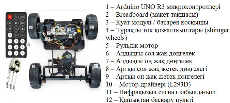
Сурет 6 – Әзірленген мобильді робот платформасының эксперименттік прототипі.
