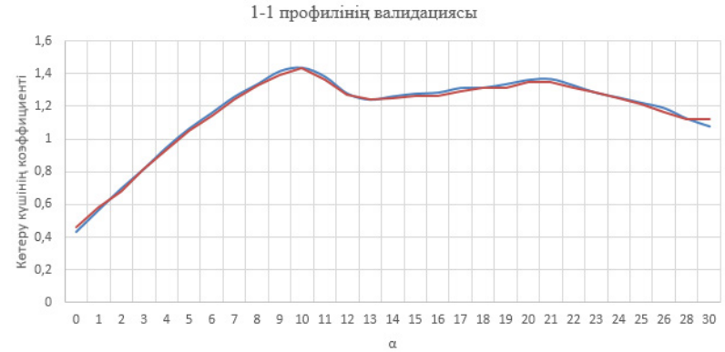
а) Параметр: көтеру коэффициенті C_l
