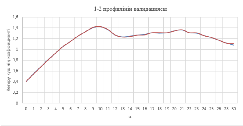
а) Параметр: көтеру коэффициенті C_l
