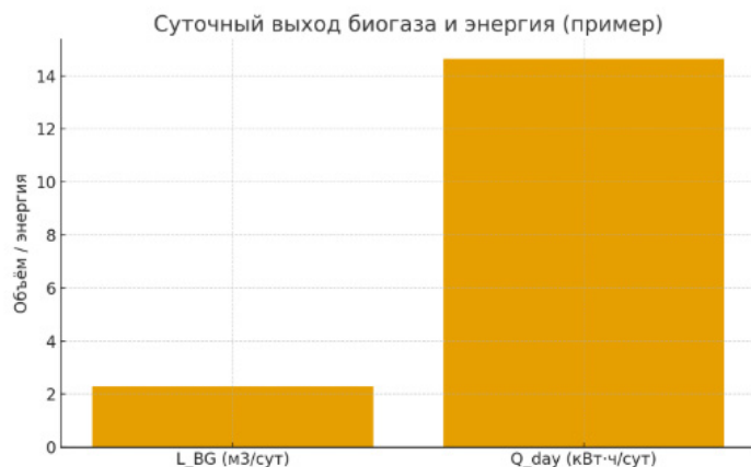
Рисунок 3 – Суточный выход биогаза (м 3 /сут) и соответствующая тепловая энергия (кВт·ч/сут) при переработке 10 т/сут навоза.
