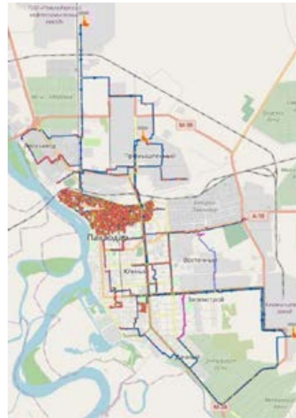
Рисунок-2 – Схема тепловых сетей г.Павлодара (ПО ZuluGIS)
