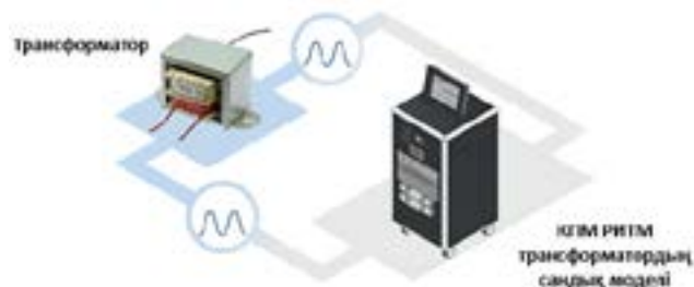
3-сурет – Сандық ұқсастық схемасы
