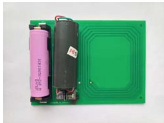
Рисунок 4 – Внешний вид генератора преднамеренных электромагнитных помех
