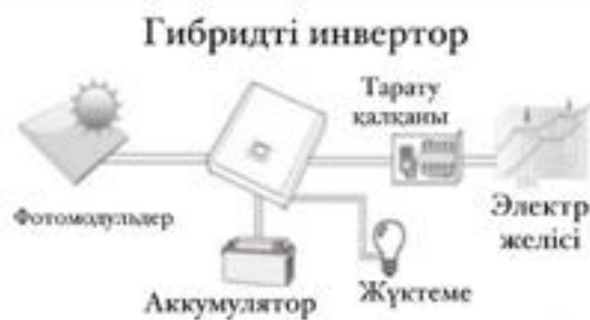
1-сурет – Күн ЭС функционалдық схемасы
