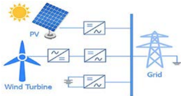
1-сурет – Электр желісіне қосылған жаңартылатын энергияның гибридік жүйелері [10].
