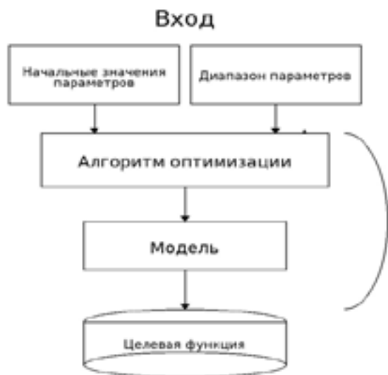
Рисунок-1 – Схема ЛП-модели производственной системы
