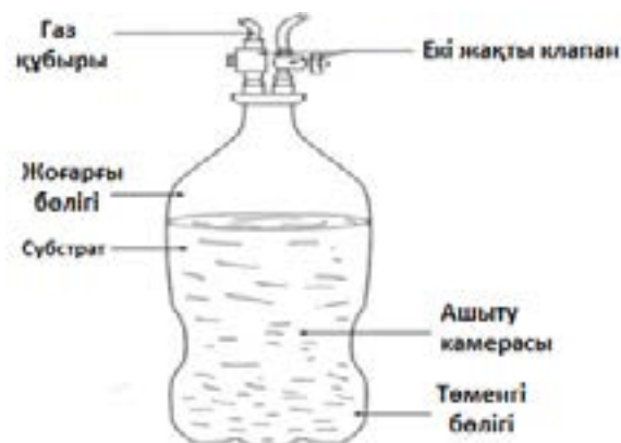
2-сурет – Ашыту үшін қондырғының схемалық диаграммасы
