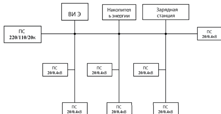
Рисунок 3 – Перспективная структурная схема распределительной сети напряжением 20 кВ
