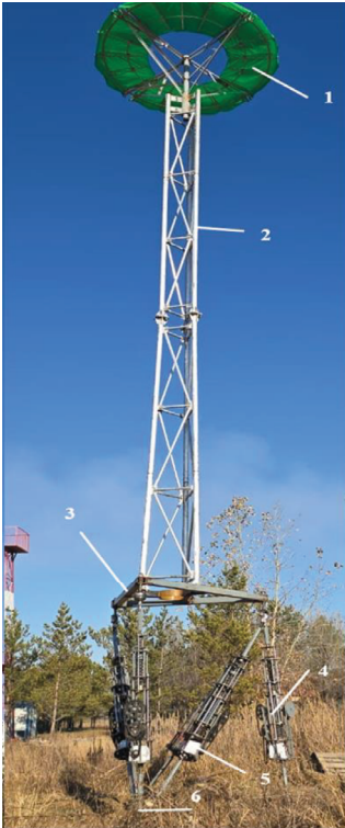
Рисунок 1. Экспериментальный образец ПВЭС с качающимся зонтовым парусом
