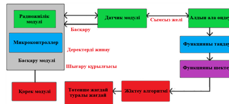
3-сурет—LWSN үшін ағып кетуді анықтау жүйесі
