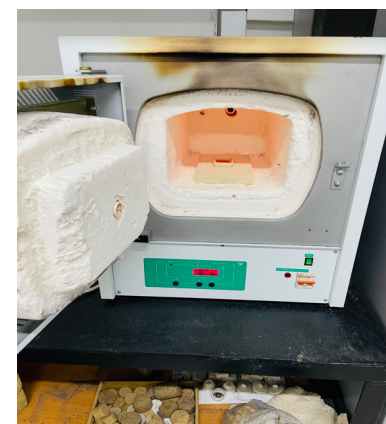
Рисунок 1 – Муфельная печь для прокалки нефтяного кокса
