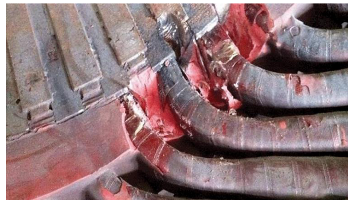
Рисунок 2 – Последствия воздействия периодически повторяющихся ЧР на обмотку статора электрической машины
