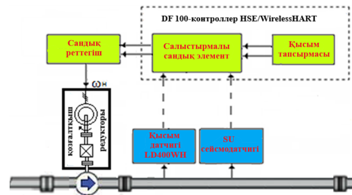
1-сурет – WirelessHART технологиясы негізінде магистральдық газ құбыры бойындағы газдың ағуын анықтау әдістемесіне құрылымдық сұлбасы
