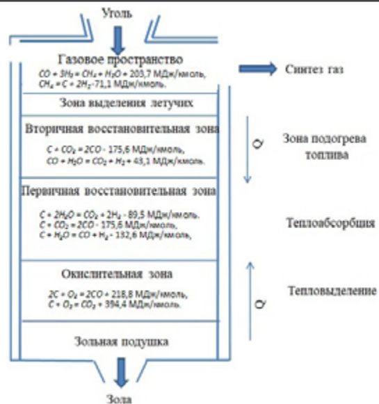
Рисунок 2 – Реакционные зоны в газификаторе
