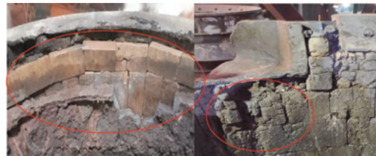
Рисунок 1 – Зоны наибольшего износа футеровки разливочного ковша
