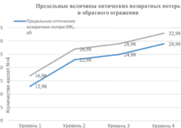
Рисунок 2 – Показатели значений предельных оптических возвратных потерь и предельных величин обратного отражения для муфтового соединения с числом касет N=4
