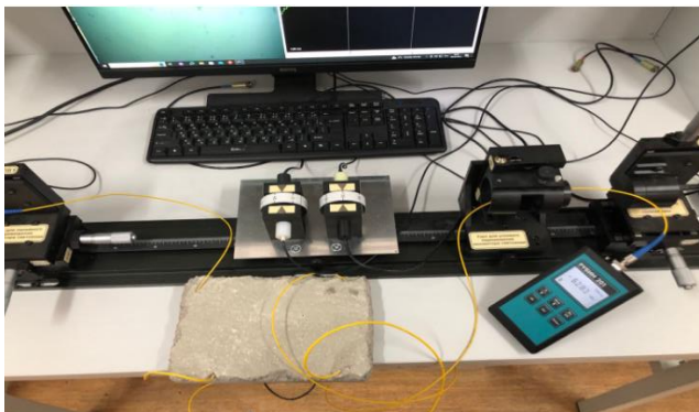
Рисунок 1 – Экспериментальная установка для определения деформаций на поверхности бетонных конструкций
