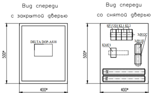
Рисунок 3 – Общий вид шкафа защиты
