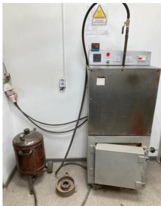
Рисунок 2 – а) Стенд на абразивный износ, б) Принципиальная схема стенда
