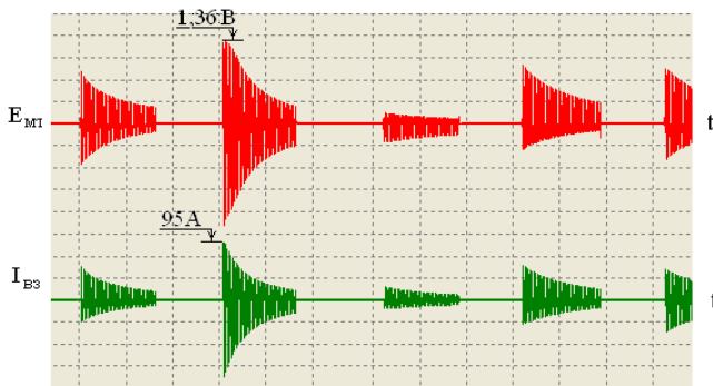
Рисунок 4 – Осциллограммы включения в сеть трансформатора ТТ-6 в режиме холостого хода
