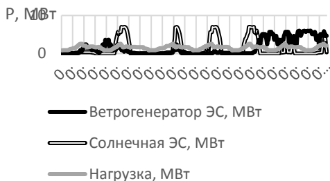
Рисунок 5 – Графики зависимости выработки и потребления энергии в весенний сезон
