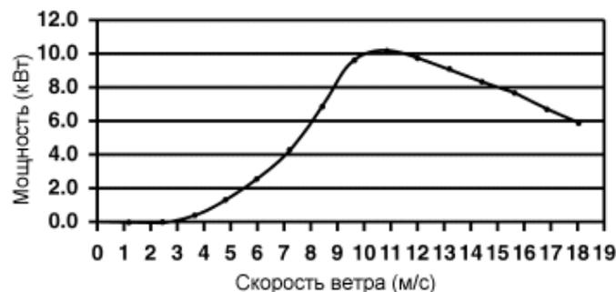
Рисунок 11 – Зависимость мощности от скорости ветра
