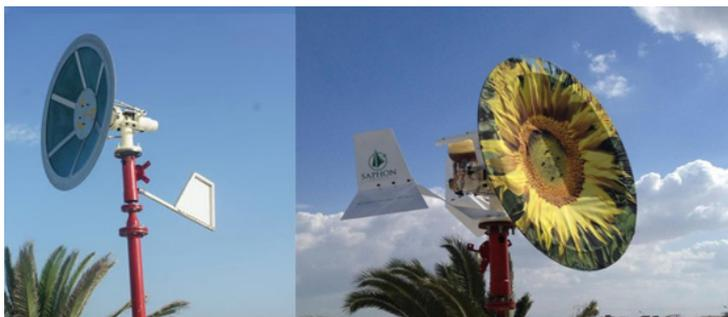
Рисунок 9 – Ветрогенератор по типу парусника
