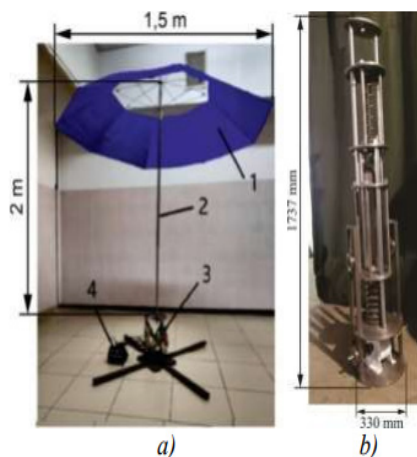
Рисунок 1 – ПВЭС с качающимся зонтовым парусом: а) демонстрационная модель (1: парус; 2: мачта; 3: МП; 4: измерительный прибор); б) опытный образец (76 кг)
