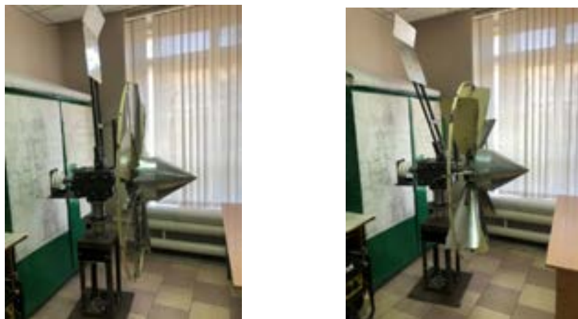
Рисунок 13 – Общий вид ветроэнергетической установки с положением лопастей при скорости ветра соответствующей рабочей и при скорости значительно превышающей рабочую
