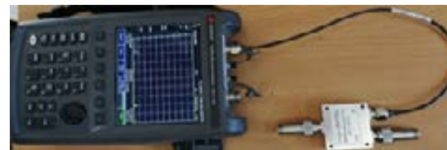
Рисунок 11 – Схема измерения КСВ обратного порта делителя
