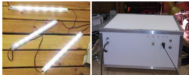
Рисунок 2 – Светодиодные светильники и преобразователь напряжения ГНУ ВИЭСХ
