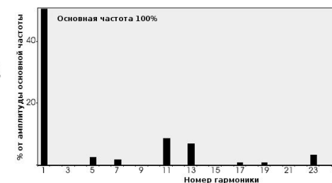
Рисунок 8 – Спектр гармоник типового две-надцатиимпульсного моста
