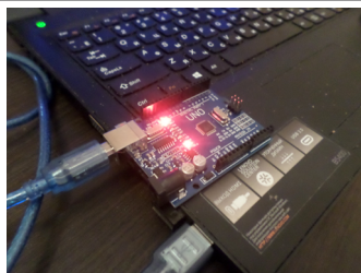
Рисунок 5 - Подключение платы Arduino Uno к персональному компьютеру при помощи USB-шнура
