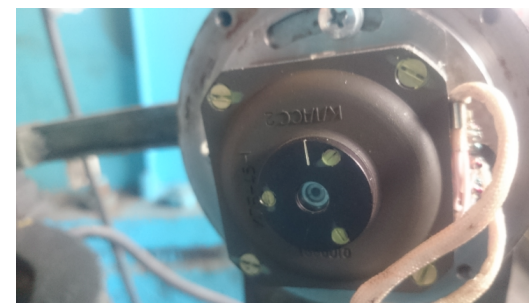
Рисунок 5 – Датчик положения СВД, вид спереди (снята крышка)
