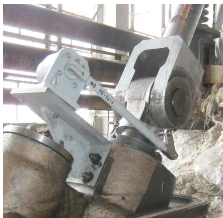
Рисунок 6 – Датчик положения СВД, вид сзади (на переднем стуле)
