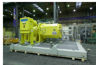
Рисунок 1 – Электроприводные газоперекачивающие агрегаты конструкций MORICO и HOFIM
