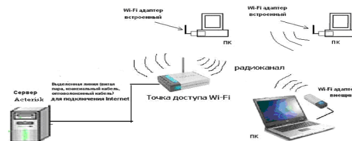
Сурет 1 – Asterisk серверінің пайдаланушымен сымсыз желі арқылы байланысын ұйымдастырудың құрастырылған сызбасы
