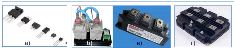
Рисунок 1 – Элементная база преобразователей: а – транзисторы, б – тиристоры, в и г – силовые модули
