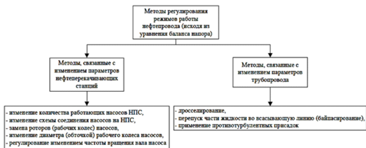
Рисунок 1 – Методы регулирования режимов работы нефтепровода, исходя из уравнения баланса напоров
