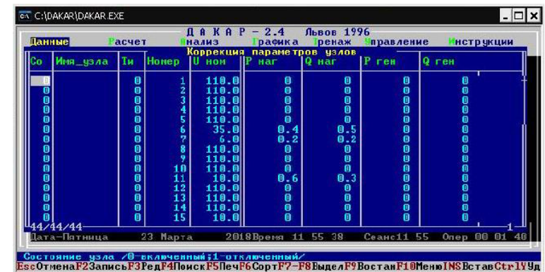
Рисунок 6 – Окно редактирования узлов электрической сети
