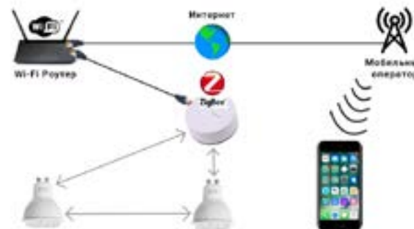
Сурет 1 – Үй желісімен және интернетпен байланысу үшін хаб Wi-Fi маршрутизаторына қалыпты бұралған жұп кабелі арқылы қосылуы
