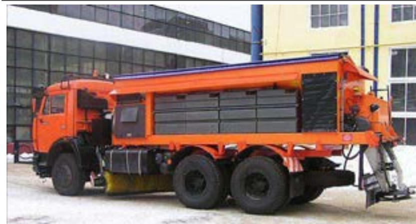
Рисунок 1 – Машина для распределения увлажненных противогололедных материалов КДМ ЭД – 4056
