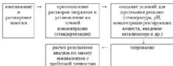
Рисунок 1 – Общая схема титриметрического анализа
