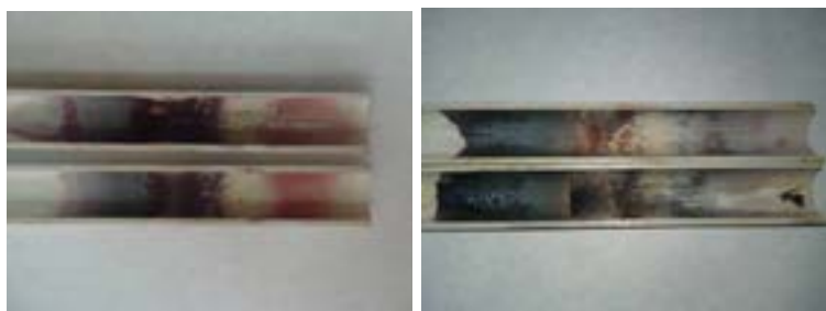
Рисунок 5 – Фотографии конденсата в разъемном фарфоровом конденсаторе в результате прямой вакуумной дистилляции селенсодержащих пылей
