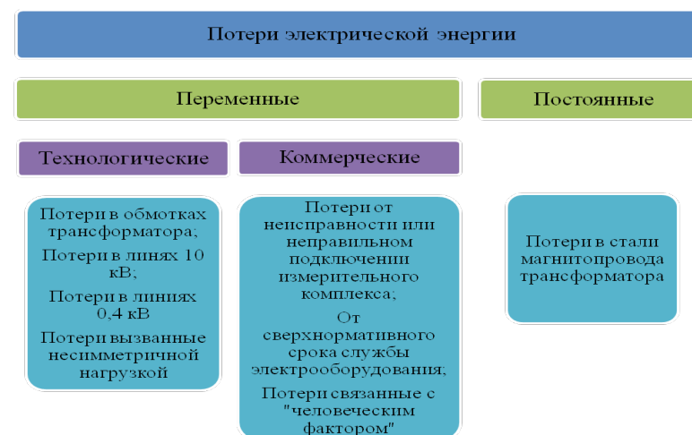
Рисунок 1 – Структура распределения потерь возникающих при передаче и/или распределения электроэнергии в сетях 10-0,4 кВ
