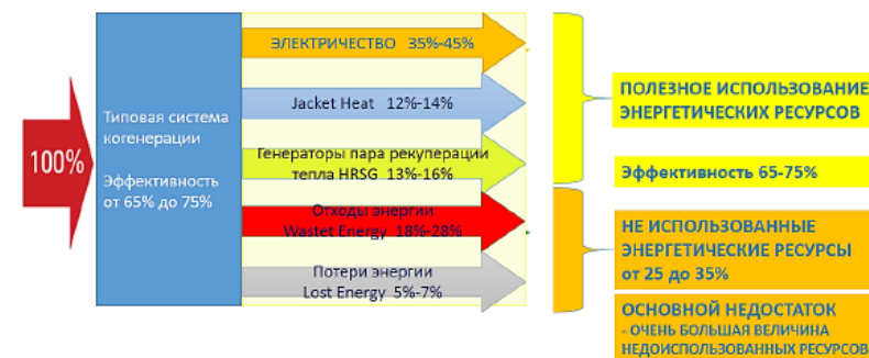
Рисунок 1 – Схема использования энергетических потоков в обычной технологии когенерации
