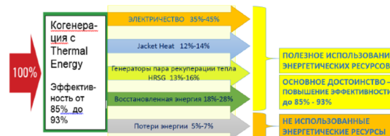
Рисунок 2 – Схема использования энергетических потоков в предлагаемой высокоэффективной технологии когенерации
