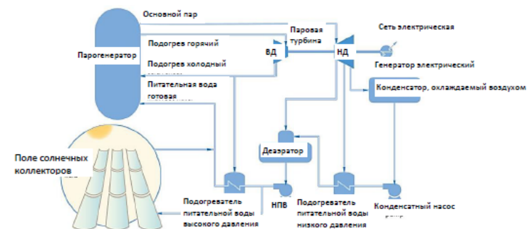
Рисунок 5 – Схема нагрева питательной воды электростанции с использованием солнечной тепловой энергии
