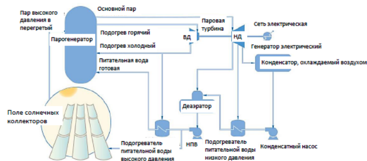
Рисунок 6 – Генерация пара высокого давления с использованием солнечной энергии
