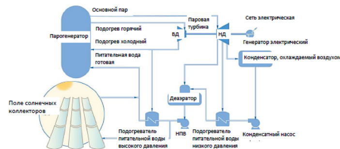
Рисунок 5 – Схема нагрева питательной воды электростанции с использованием солнечной тепловой энергии
