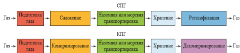
Рисунок 1 – Технологические этапы СПГ и КПП транспортировки
