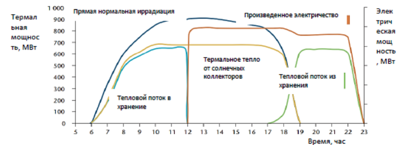
Рисунок 3 – Кривые генерации энергии в интегрированной тепловой станции
