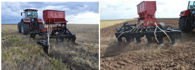
Рисунок 7 – Полевые испытания чизеля-удобрителя
