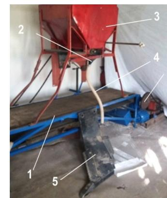
1 – бегущая лента, 2 – туковысеивающий аппарат, 3 – бункер, 4 – тукопровод, 5 – чизельный рабочий орган с рассеивателем, 6 – привод.
