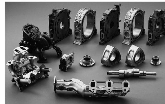
Рисунок 2 – Двигатель Ванкеля в разобранном виде
