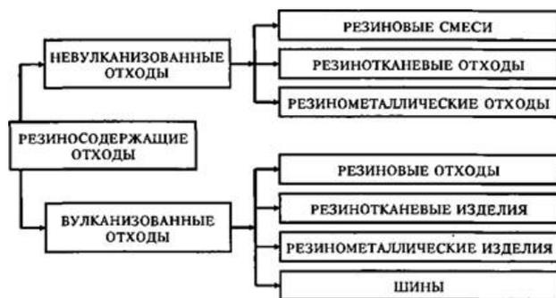
Рисунок 1.1 – Классификация резиносодержащих отходов
