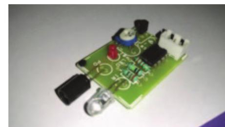
Рисунок 3 – Инфракрасный датчик
