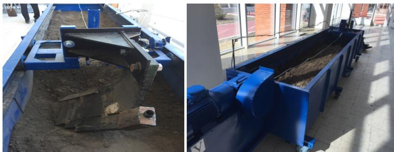
Рисунок 3 – Определение тягового усилия на почвенном канале
