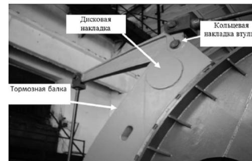
Рисунок 3 – Практическое использование элементов усиления конструкции при ремонте конструкции ШПМ компании АО «АрселорМиттал Темиртау»
