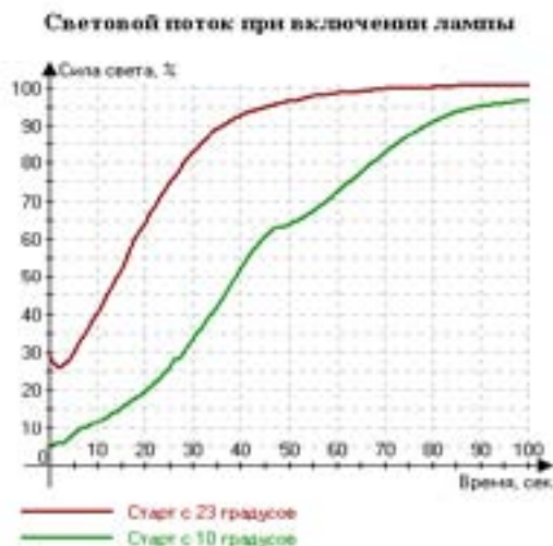
Рисунок 4 – Изменение светового потока при включении энергосберегающей лампы от сети
