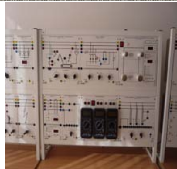
Рисунок 1 - Фотография стенда для изучения вопросов электробезопасности
