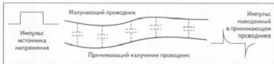
Рисунок 2 - Импульсная наводка через емкостную связь между проводниками
