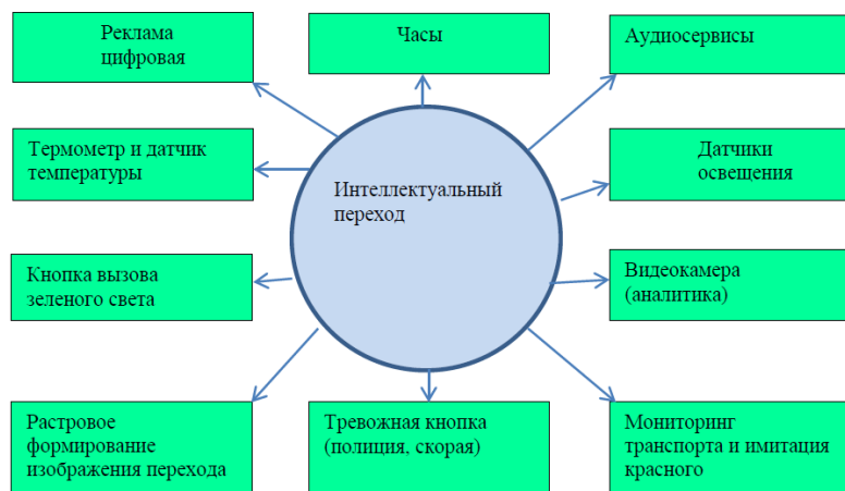
Рисунок 2 – Структурная схема сервисов и автоматики пешеходного перехода
