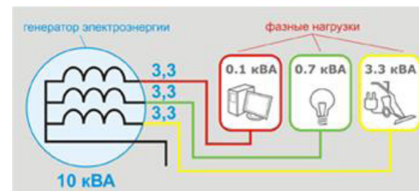
Рисунок 10 – Подключение нагрузки напрямую к сети
