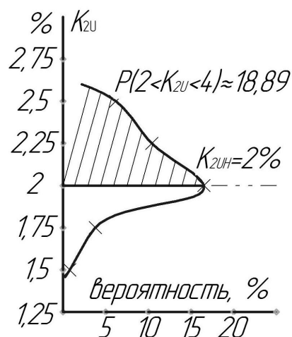
Рисунок 3 – График нормальной плотности вероятности распределения \varphi(K_{2U} = \delta K_{2U}; 0,956; 0,939) совмещенный с нормируемыми значениями уровней ЭМС
