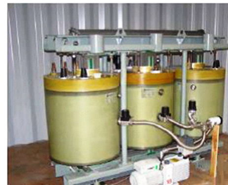
Рисунок 3 – Трехфазный ВТСП трансформатор мощностью 1 МВ·А
