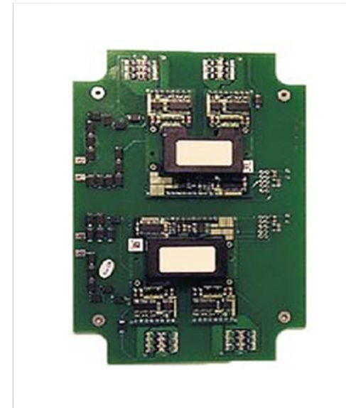
Сурет 6 – Үш деңгейлі күштік модульдің төртканалды драйвері
