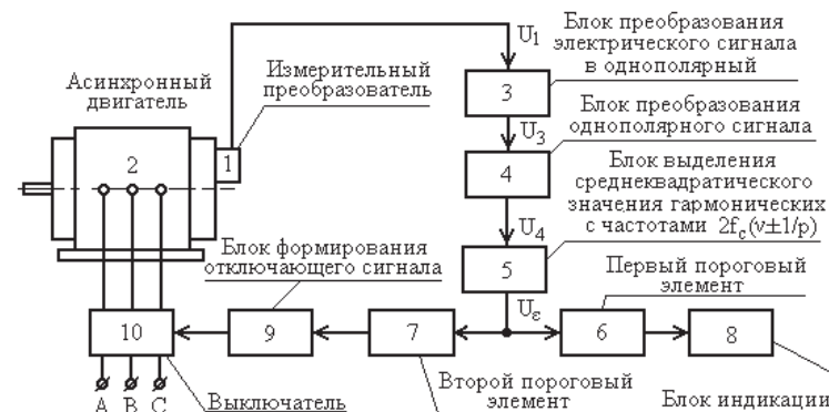
Рисунок 1 – Блок-схема для реализации способа диагностики эксцентриситета ротора АД
