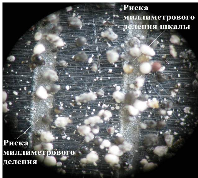
Рисунок 4 – Данные микроскопического анализа одного поля зрения после золоуловителя
