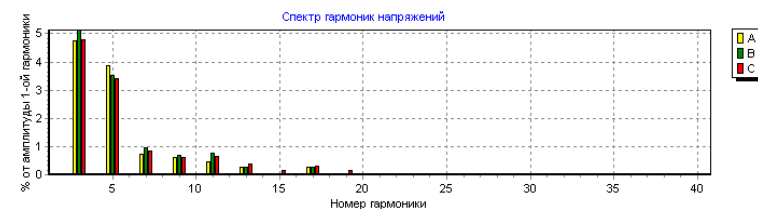
Рисунок 8 – Спектр гармоник напряжений на выводах АД в режиме х.х.
