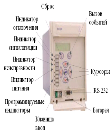
Рисунок 1 – Передняя панель реле MiCOM P123
