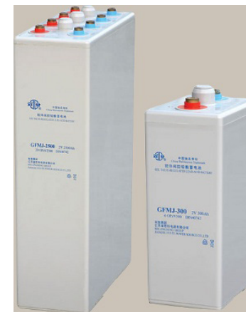
Рисунок 4 – Герметизированные аккумуляторы типа OPzV . Для выработки 50 кВт в течении 4-х часов, необходима общая ёмкость АКБ 4200 Ач* 48 В
