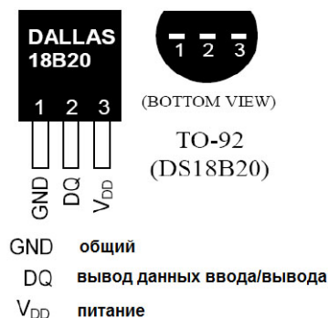
Рисунок 2 – Распиновка датчика температуры DS18B20
