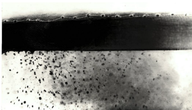
Рисунок 3 – Явление выброса капель жидкости из паровой структуры вида 0.14 \times 0.4 ; q = 94 \times 10^3 \text{ Вт/м}^2 ; \tilde{m} = \frac{m_{\text{ж}}}{m_{\text{п}}} = 1.1 .
