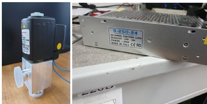
Сурет 3 – а) LCPV16EKA электр вакуумдық клапаны (EDWARDS); б) S-250-24 қуат блогы (24В, 250 Вт)
