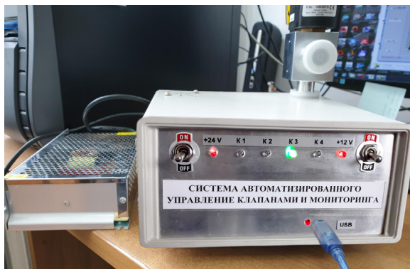
Сурет 5 – S-250-24 қуат блогы бар және К3 клапаны қосылған клапан реттегіші
