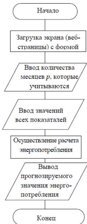
Рисунок 1.4 – Алгоритм работы пользователя с проектируемым ПО
