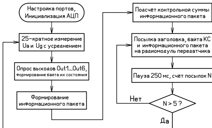
Рисунок 3 – Алгоритм программы передатчика
