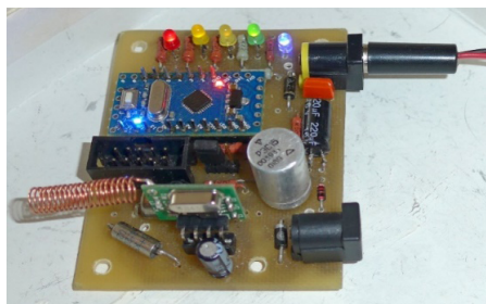
Рисунок 2 – Структурная схема и внешний вид опытного образца передатчика
