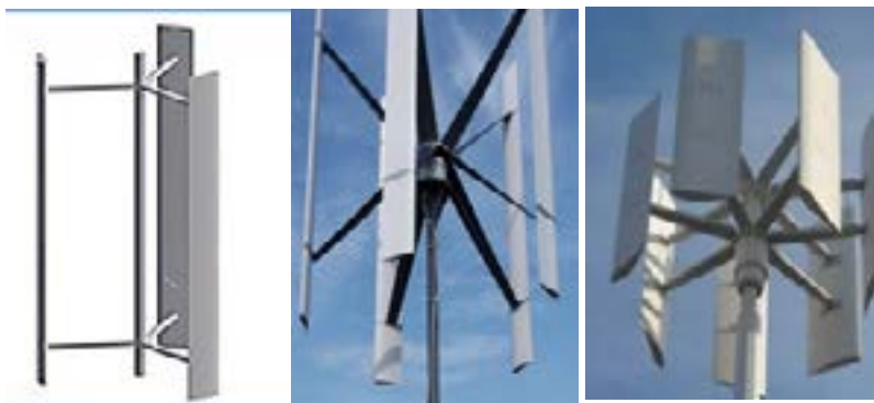
Рисунок 5 Ветрогенератор с вертикальным (ортогональным) ротором и прямыми лопастями
