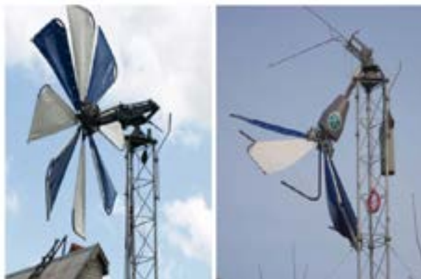
Рисунок 10 – Новая (а) и поврежденная (б) парусно–поршневые ветроэлектростанция
