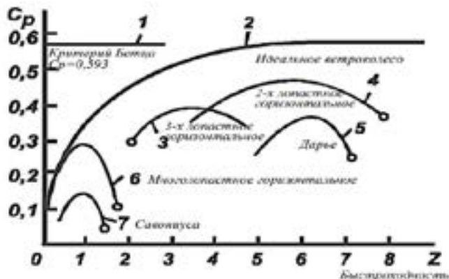
Рисунок 8 – Функциональные зависимости коэффициента использования энергии ветра C_p от быстроходности Z
