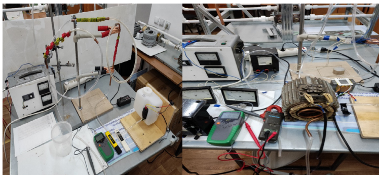
Рисунок 4 – Экспериментальная установка: а – с постоянными неодимовыми магнитами; б – с электромагнитами
