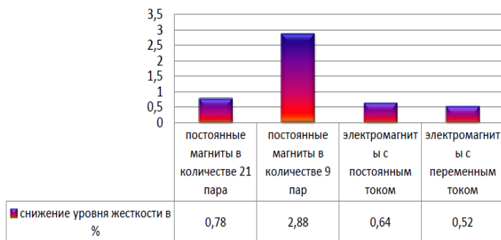
Рисунок 5 – Сравнение эффективности использования различных видов магнитов для уменьшения жесткости воды
