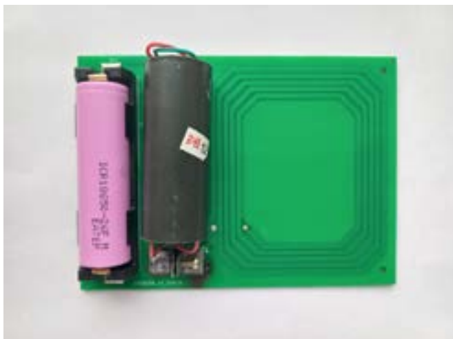
Рисунок 4 – Внешний вид генератора преднамеренных электромагнитных помех
