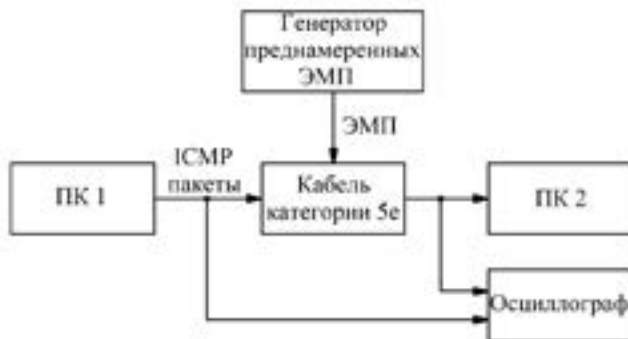
Рисунок 5 – Схема экспериментальной установки
