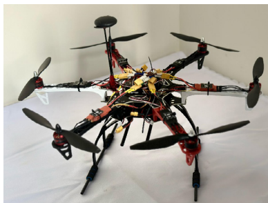
а) Гексакоптердің құрылымдық конфигурациясы және электрондық компоненттері
