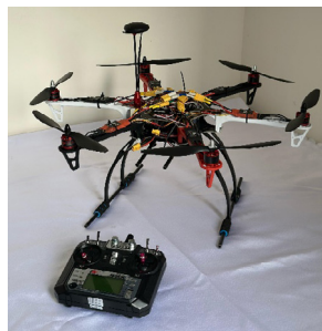
ә) Гексакоптердің ұшу алдындағы жүйелік дайындықтары және қашықтан басқару интерфейсі
