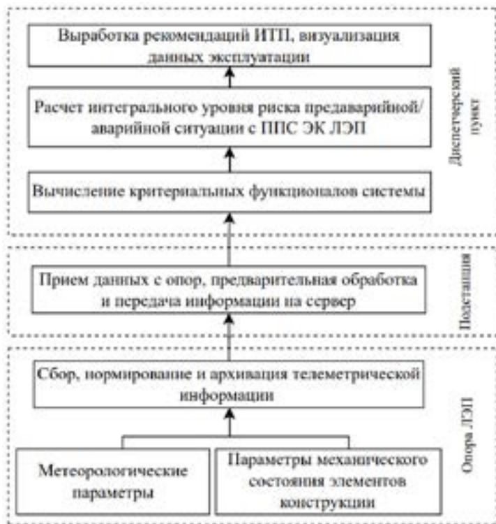
Рисунок 1 – Иерархическая функционально-информационная архитектура системы текущего контроля степени обледенения
