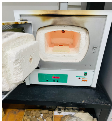
Рисунок 1 – Муфельная печь для проковки нефтяного кокса
