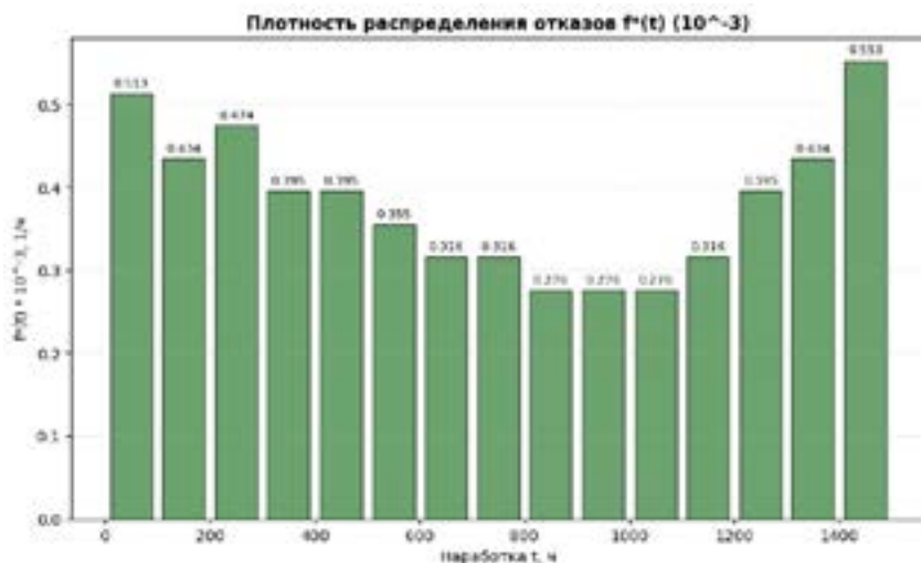
Рисунок 2 – Плотность распределения отказов
