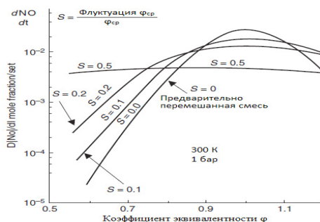
Рисунок 4 – Скорость образования \text{NO}_x как функция коэффициента эквивалентности с влиянием параметра смешивания S при 0,1, 0,2 и 0,5 [16, 17]
