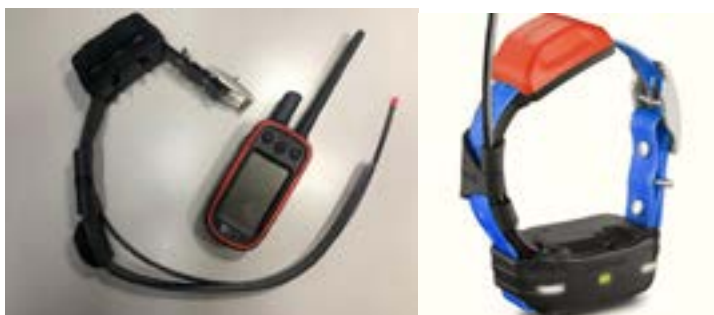
Сурет 5 – Garmin Alpha 100 VHF GPS трекері TT15c қашықтан басқару пультімен және T5mini
