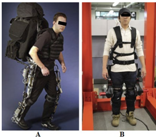
Рисунок 3 – Экзоскелеты для увеличения силы человека. (А) экзоскелет нижних конечностей Berkeley (BLEEX) В) экзоскелет HEXAR-HL
