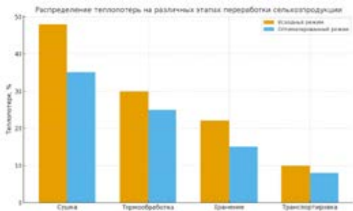
Рисунок 4 – Распределение тепловпотерь на различных этапах переработки сельхозпродукции (исходный и оптимизированный режим)
