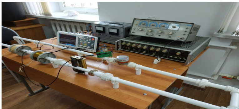
Рисунок 2 – Устройство для исследования процессов электромагнитной и магнитной обработки воды
