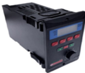
5 – сурет «Электромеханикалық кешендерді оңтайлы басқару» зертханалық стендінің JET-075GT жиілік түрлендіргішінің жалпы көрінісі
