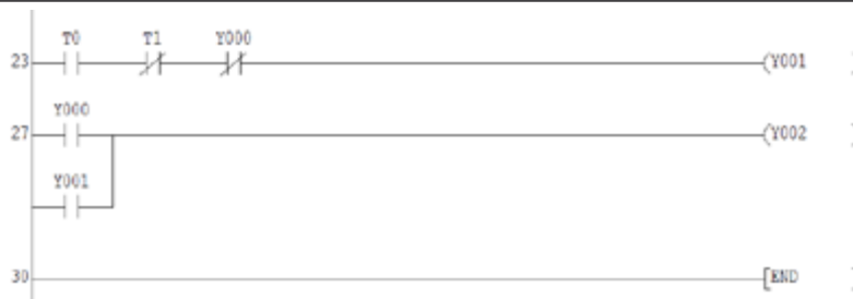
Сурет 9 – Жылжымалы есікті автоматты басқару бағдарламасының релелік диаграммасы
