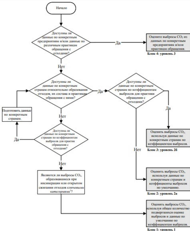
Рисунок 1 – Схема принятия решений относительно выбросов CO<sub>2</sub>
